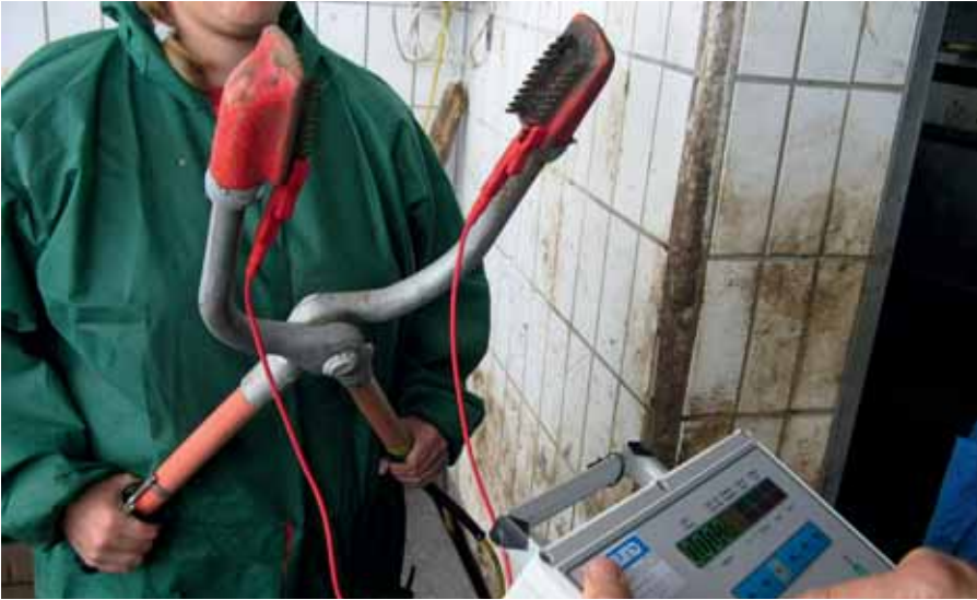
Überprüfung einer Elektrobetäubungszange durch das bsi ©
