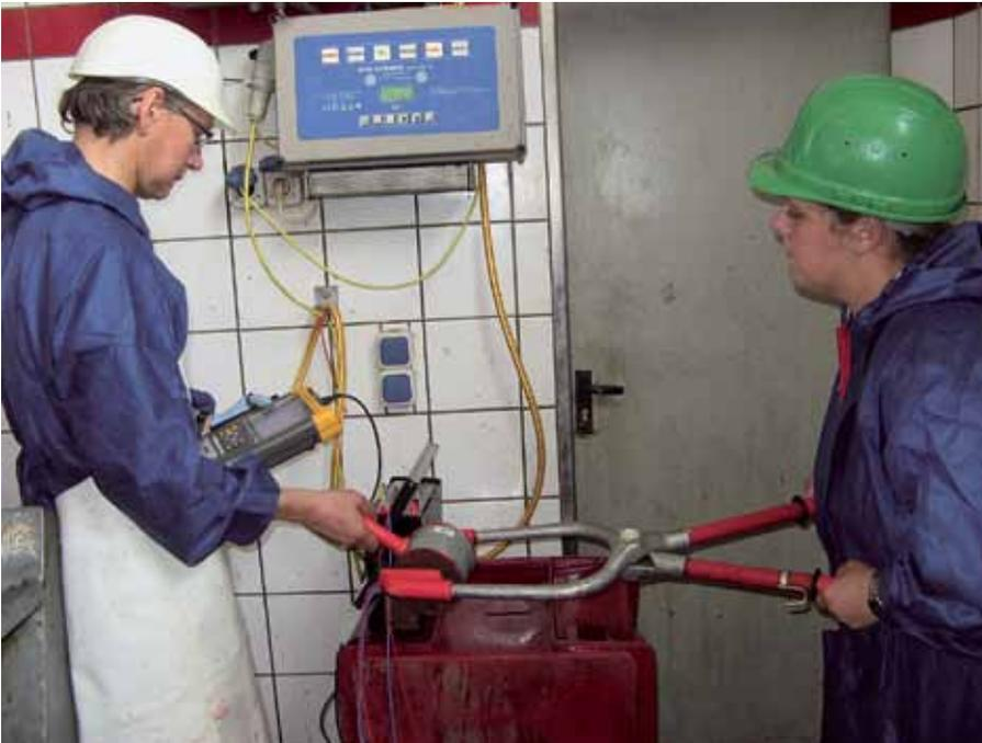
Überprüfung einer Elektrobetäubungsanlage
