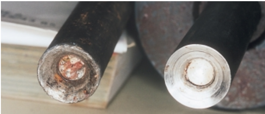
Defekter und intakter Schussbolzen
