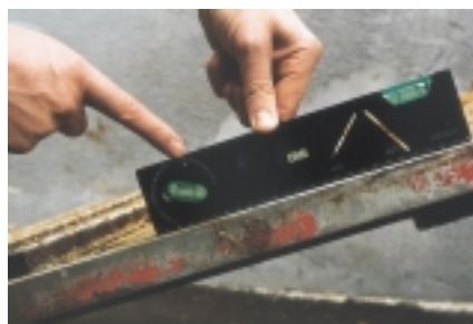
Messung der Laderampenneigung
