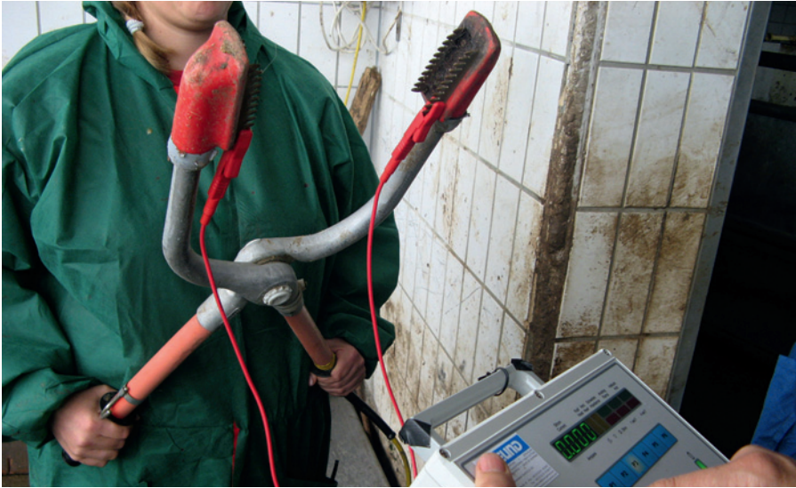
Überprüfung einer Elektrobetäubungszange durch das bsi ©
